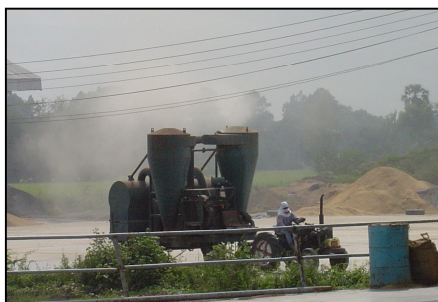
รูปที่ 3-15 การติดตั้งท่อลมดูดฝุ่นไว้กับรถเกลี่ยและรถกวาดข้าวเปลือก
