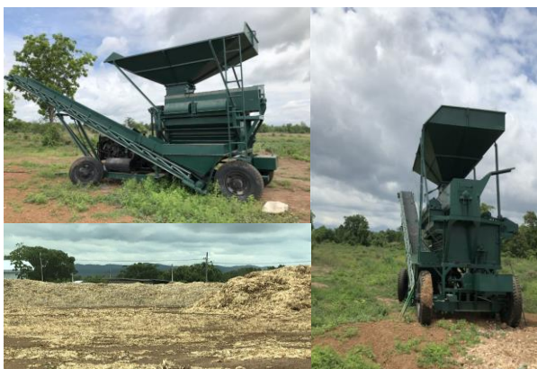
สหกรณ์การเกษตรเพื่อการตลาดลูกค้า ธกส. ลำปาง จำกัด จ. ลำปาง เครื่องสีข้าวโพด ขนาด 195 แรงม้า
