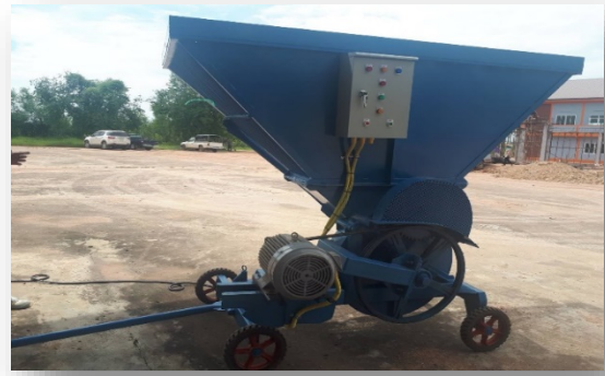
เครื่องสับมันสำปะหลัง สหกรณ์ การเกษตรเมืองชัยภูมิ จำกัด จ.ชัยภูมิ
